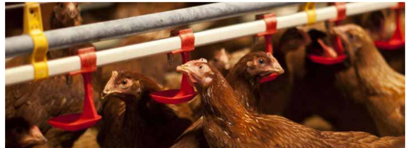
Les lignes d'abreuvement sont complétées par: des régulateurs de pression, des unités d'évent à lavage intégré, filtres, doseurs de médicaments et compteurs de litres et des accessoires de levage qui permettent de soulever les équipements en fonction de la croissance de l'animal et pour les opérations de nettoyage en fin de cycle.
