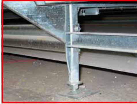
El particular aplastamiento en el fondo de la pata, asegura una mayor estabilidad estructural y el pié regulable permite de compensar las imprecisiones en el suelo del galpón.
