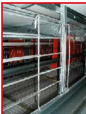
La puerta corredera preparada para poder ejercer una apertura total o parcial, está montada en un marco especial que garantiza la funcionalidad y elimina el riesgo de desenganche.
