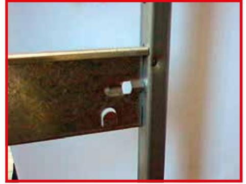
El diseño especial del travesaño de la pata permite de montar el divisor centrado en la pata, usando al máximo el espacio de la celda sin crear zonas donde se acumule la suciedad.
