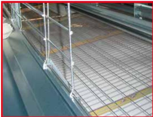
Debido a su tecnología de construcción, Facco única entre los fabricantes en el mundo ofrece alambres de soporte horizontales integrados en el diseño del divisor garantizando así un perfecto apoyo del fondo de la jaula que, incluso cuando está cargada con el peso de muchos animales, no se dobla acumulando los huevos en el centro y optimizando el tiempo de montaje.
