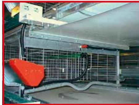
El segundo rascador colocado en el retorno de la cinta de gallinaza, asegura una limpieza a fondo de la cinta en una zona no afectada por las plumas.
