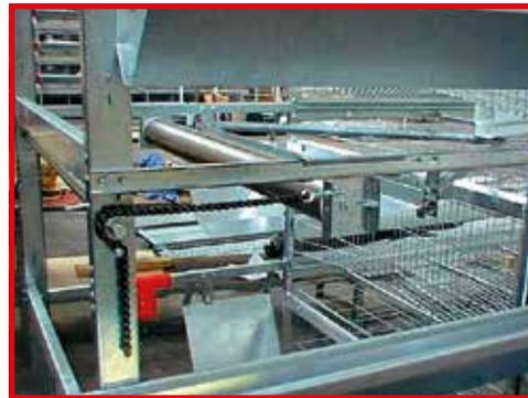
La contrapunta ha sido diseñada para permitir la registración de la correa y un fácil mantenimiento.
