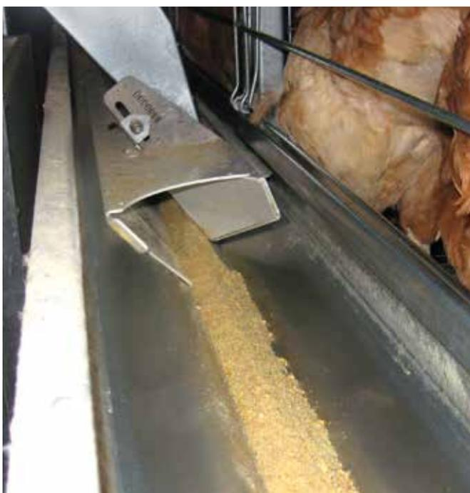
Mangeoires en aluzinc d'une épaisseur de 8/10 de mm avec profil anti-gaspillage spécialement conçu pour le chariot niveleur de distribution de l'aliment.
