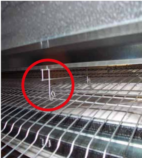
En même temps, ce système de « fixation » crée un joint rigide à la structure de la batterie permettant ainsi une excellente stabilité même en cas de contraintes transversales.
