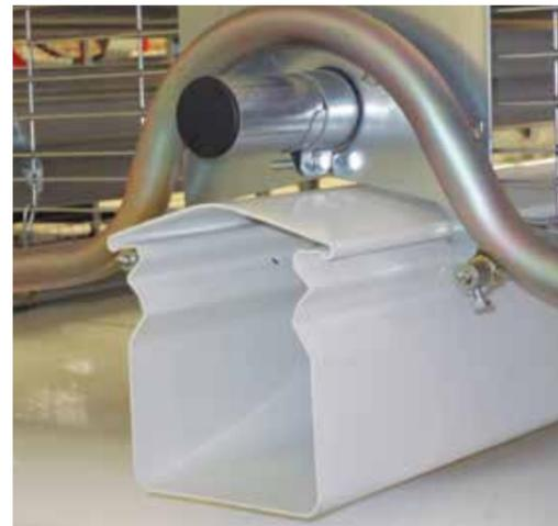
La batterie a la possibilité d'être munie d'un tube pour le séchage des fientes **directement sur les tapis** d'extraction.
