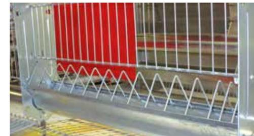
La batterie "EURO C3 MAX" dérive de la "EURO C3" dont elle maintient la longueur du module (2,4 m) mais qui est **plus profonde (78,2 cm)**, la caractéristique de la batterie "MAX" est d'avoir une **mangeoire à l'intérieur du module**, ce qui permet de respecter la normative avec **50 animaux/module (par rapport aux 40 de la EURO C3)**.
