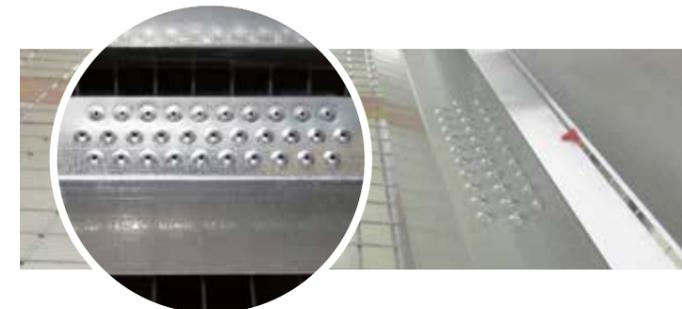
Le système de limage des griffes est constitué d'un **moletage** de la branle frontale en assurant ainsi l'efficacité maximale sans avoir besoin de parties supplémentaires. Ce type de finition résulte **simple, propre et efficace**.
