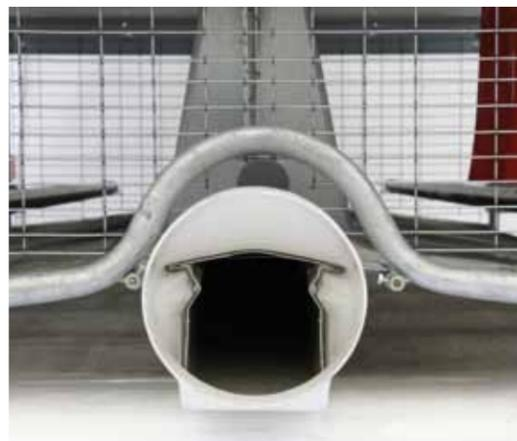
La batteria **MAGNUM** può essere provvista del tubo per l'essiccaggio della pollina direttamente sul nastro di asporto.
