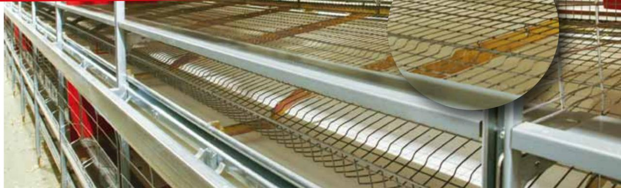
Le fond est soutenu par une traverse métallique qui, grâce au traitement de passivation, est rendue très résistante à la corrosion. Cette conformation confère à l'ensemble de la structure solidité et stabilité. En soutenant la grille métallique par en-dessous, on évite la formation d'obstacles à l'intérieur de la cage qui pourraient gêner la descente des œufs et le mouvement des animaux.
