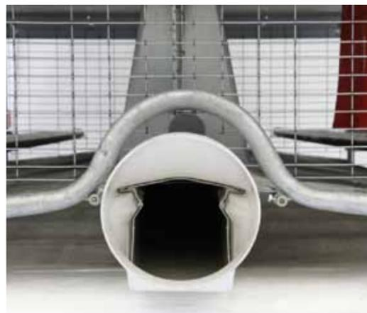
La batterie « **MAGNUM** » peut être équipée du tube de séchage de la fiente directement sur la bande d'évacuation.
