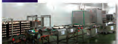
Détection sans contact des œufs retournées et fêlés.
