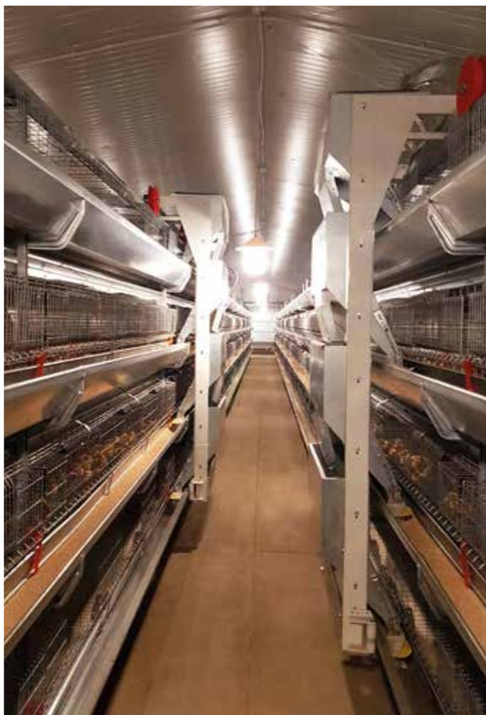
Кормораздача осуществляется с помощью самоходной тележки, буксируемой стальным тросом. Благодаря сочетанию специально разработанного выравнивающего устройства и кормушки, которая была специально спроектирована для клеточной батареи для молодняка, имеется возможность получить очень точное распределение кормов, модулируемое по необходимости, что является основополагающим фактором в первые дни жизни цыплят, в целях гарантирования равномерности распределения корма.
