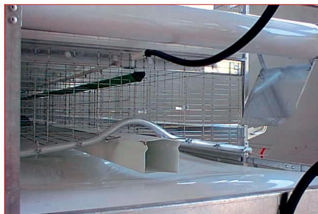
Модель с каналом системы подсушки помета, размещенным под клеткой, идеальна для птичников умеренной длины, и позволяет использовать всю ширину клетки. Специально разработанный канал, расположенный выше проволоки полка гарантирует полное очищение своей верхней части при передвижении птицы.
