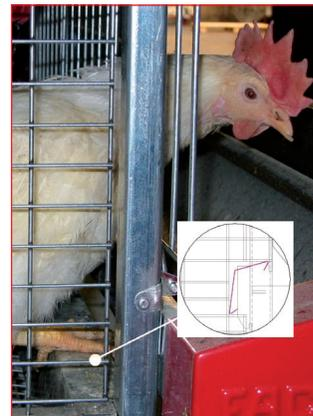
Дефлектор сохранения яйца разработан таким образом, что позволяет избежать случайного повреждения яйца при жесткой хватке лапой птицы. В то же самое время система «сцепления» создает прочное соединение структуры батареи, что позволяет увеличить ее устойчивость.
