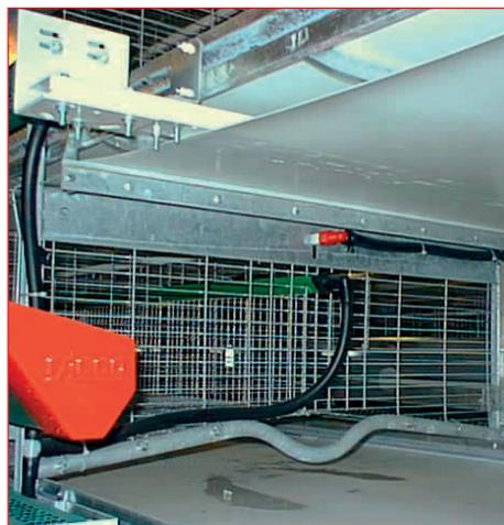
Второй скребок, расположенный на обратной стороне ленты пометоудаления перед стойкой последней клетки в зоне, где нет пера, обеспечивает максимальное очищение.
