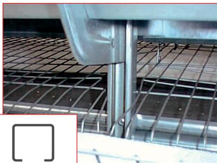
Специальные согнутые 4 раза стойки клетки обеспечивают как максимальную силу благодаря толщине, так при этом и легкую чистку в соответствии с самым последним опытом НАССР.
