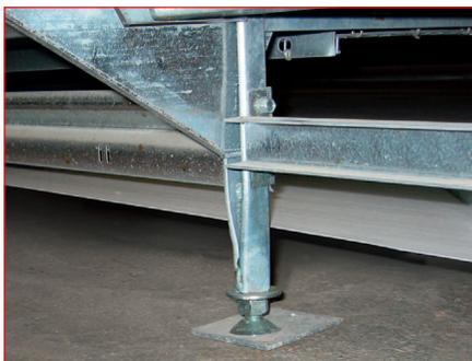
Специальная форма ножки в нижней части клетки обеспечивает более высокую устойчивость, в то время как регулируемая база позволяет компенсировать небольшие погрешности пола для достижения идеального уровня.
