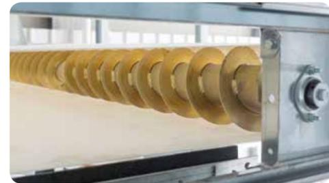
El sistema de seguridad que se monta en cada piso de la máquina permite parar inmediatamente el sistema en el caso de problemas en las cintas de polipropileno.
