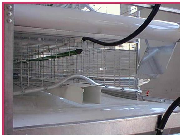
La soluzione con tubo piccolo sotto è ideale per impianti più corti e consente di ottimizzare la profondità utile della cella. Il particolare design studiato con la parte posteriore sollevata ed il tubo tutto sopra alla rete del fondo cella consente alle galline di mantenere il tubo pulito.
