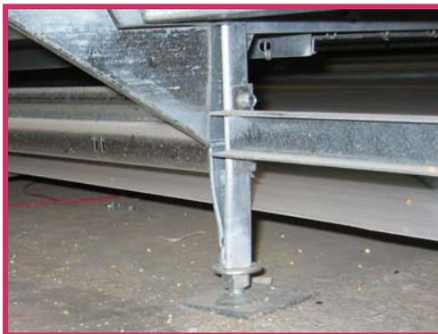
Il particolare schiacciamento della gamba in fondo garantisce una maggior stabilità strutturale ed il piedino regolabile consente di rimediare ad imprecisioni nel pavimento del capannone
