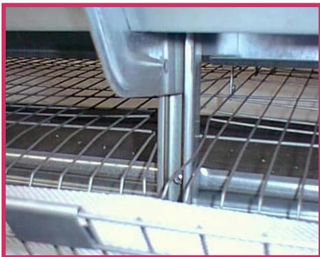
Il particolare profilo della gamba ne garantisce la massima portata grazie all'elevato spessore ed alle pieghe di irrobustimento conservando un'elevata pulibilità in linea con i più recenti concetti di HACCP.
