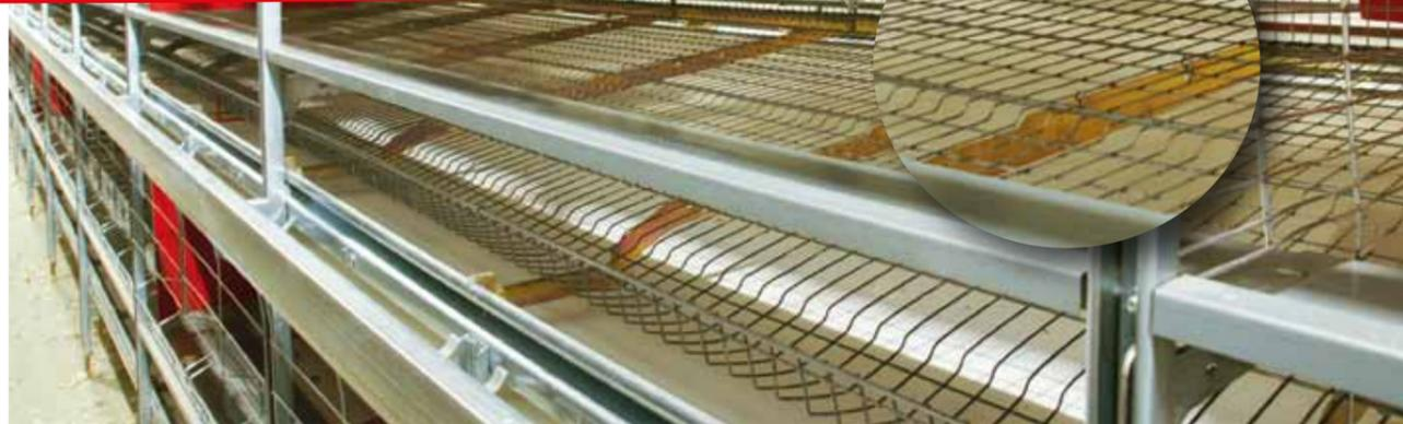
El piso está respaldado por un sostén metálico que, gracias al tratamiento de pasivación, es muy resistente a los agentes corrosivos. Esta estructura es sólida y estable en todo su conjunto. El sostén dado a la reja metálica desde abajo evita que se creen obstáculos al interior de la jaula, que impedirían el descenso de los huevos y el movimiento de los animales.
